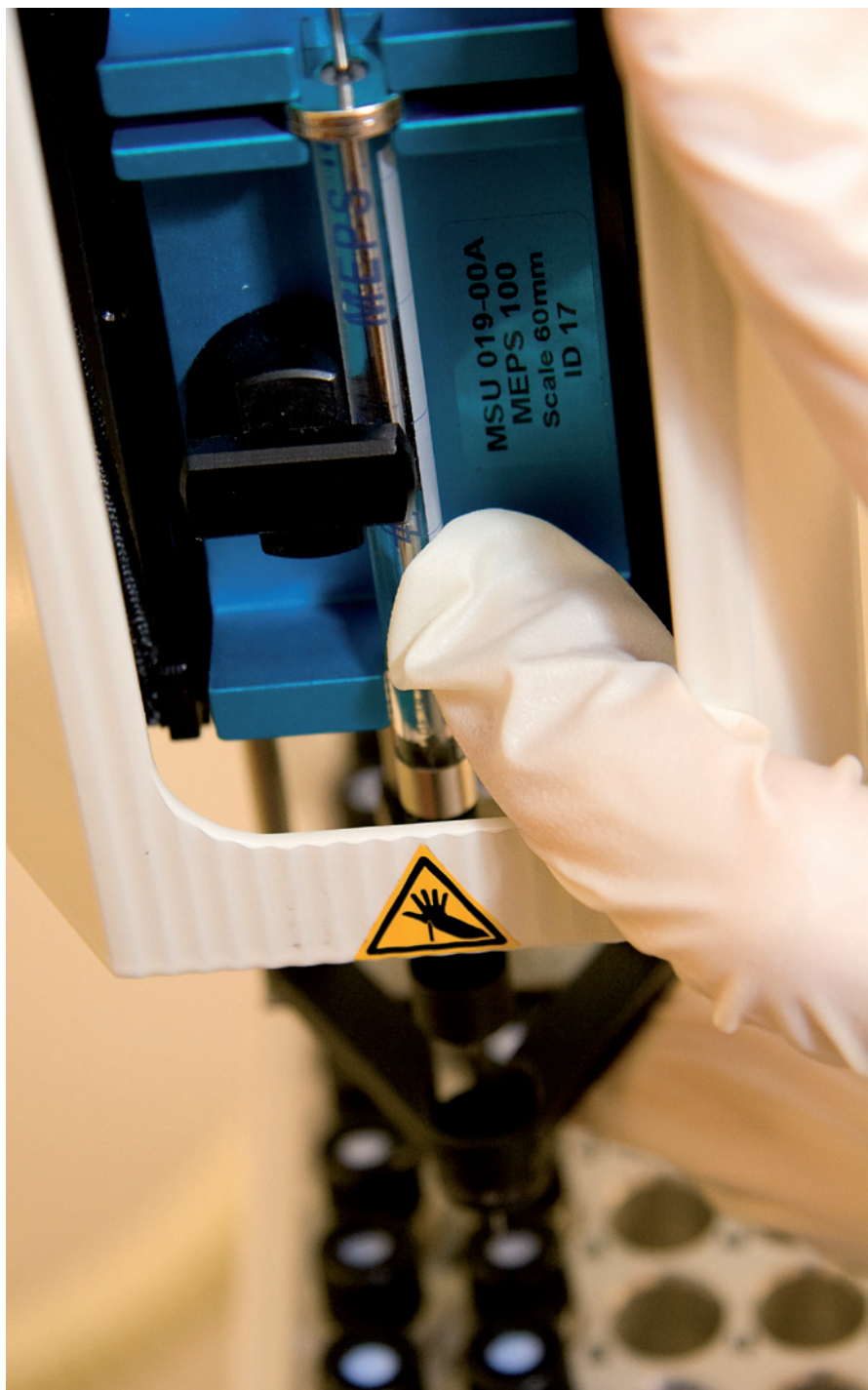
Inzetten van de MEPS-spuit in de injectienaaldhouder van een CTC CombiPAL-autosampler voor volautomatische micro-extracties.
