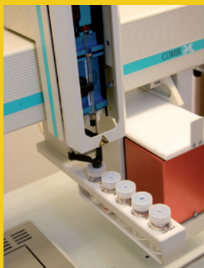
MEPS in geautomatiseerde setting met CombiPAL-autosampler.
