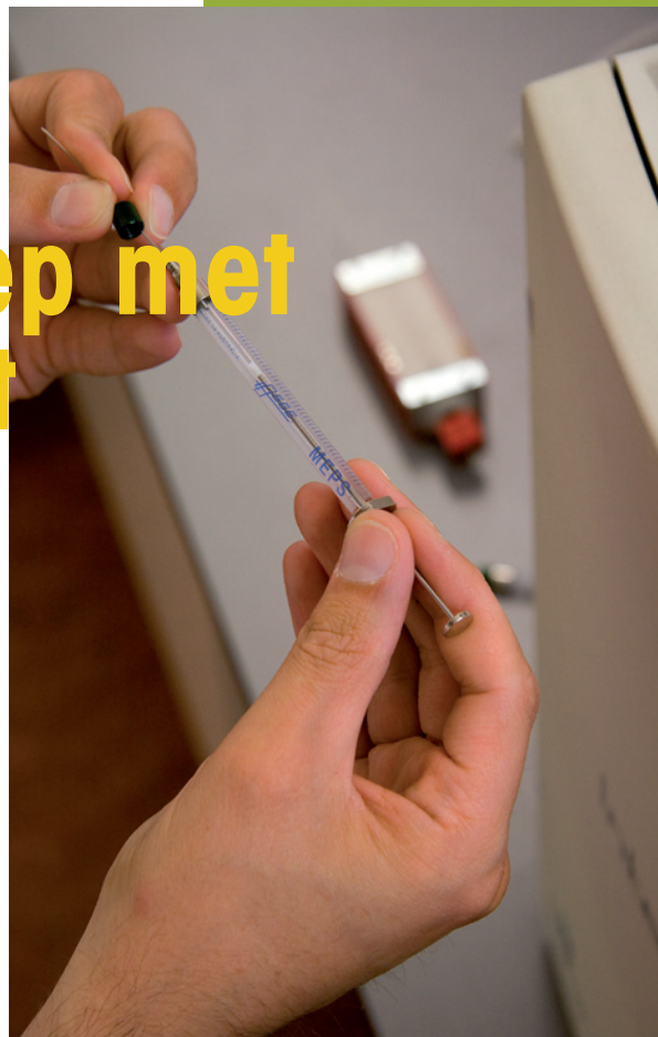
Een MEPS-kit. De stationaire fase bevindt zich in de Barrel Insert and Needle Assembly (BIN), een cilindrische houder die zich aan het eind van de naald bevindt.
