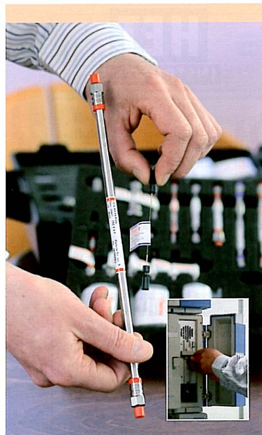
Lange HPLC-kolommen versus de korte van enkele cm's die de analyse sterk doen versnellen.
